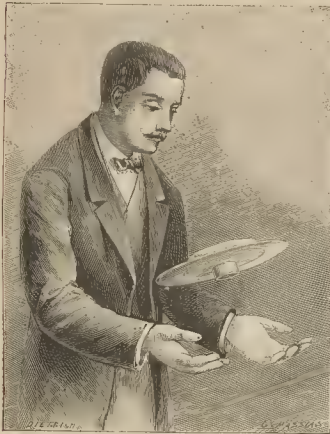
Fig. 1. Experimento de fuerza centrífuga ejecutado con un plato y un aro de servilleta
